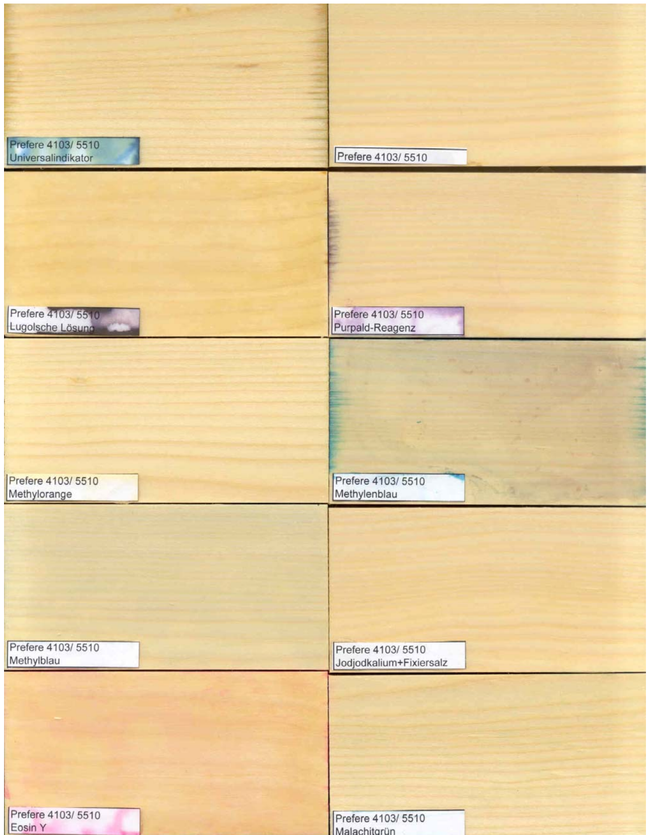
Abb. 26 Farbreaktionen auf Prefere 4103/ 5510 (UF) luftgetrocknet
