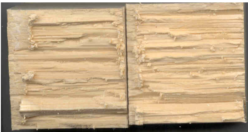
Abb. 2 Bruchfläche einer mit MUF verklebten Fichte
