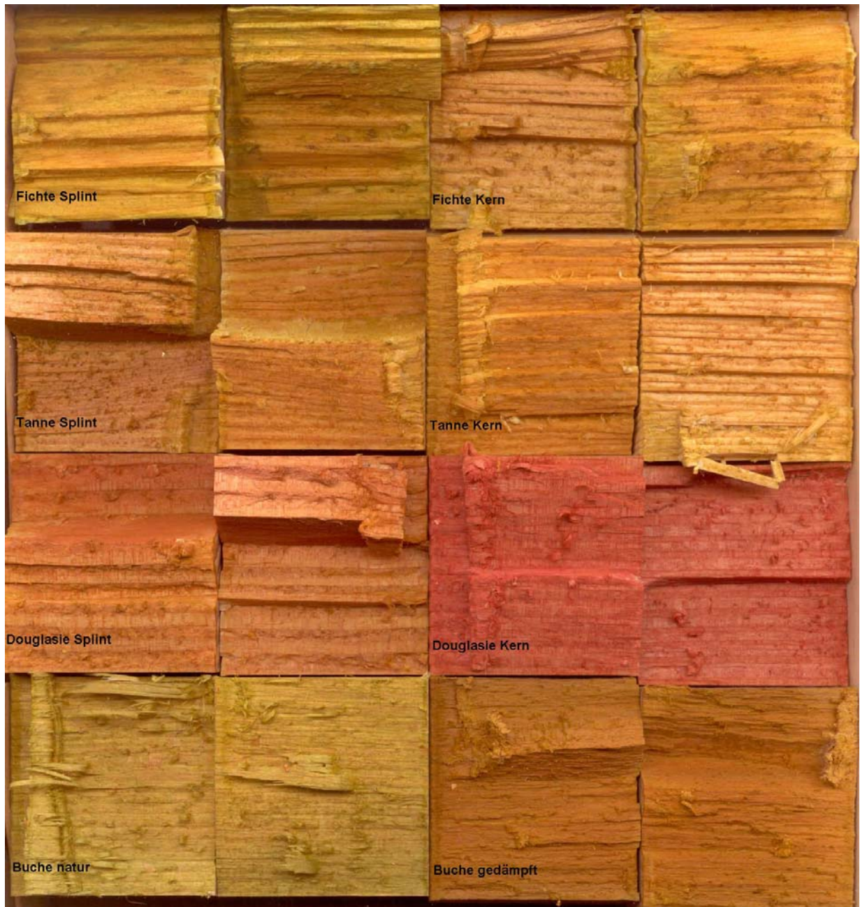
Abb. 17 Bruchflächen ausgewählter Holzarten, besprüht mit Universalindikator
