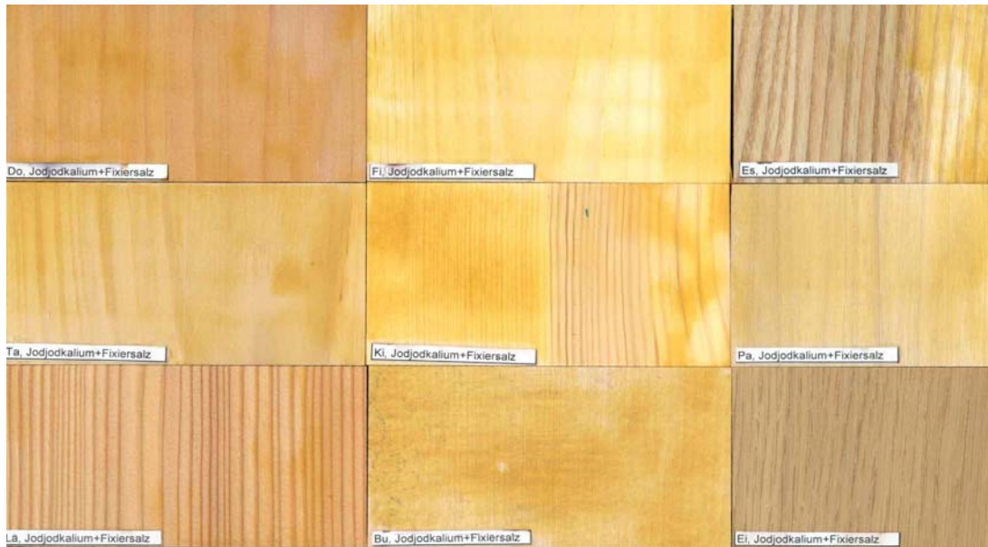
Abb. 14 Gehobelte Holzproben gestrichen mit Lugolscher Lösung + Natriumthiosulfat, luftgetrocknet
