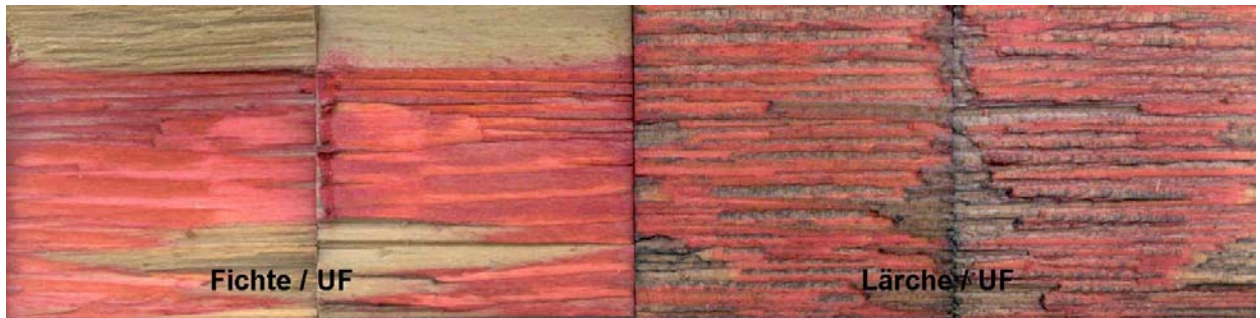
Abb. 47 DACA auf Fichte / UF bzw. Lärche / UF
