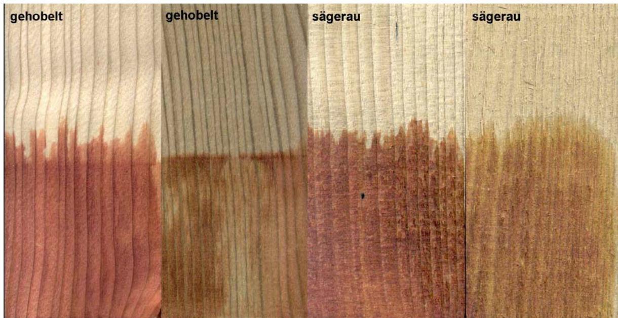
Abb. 54 DACA auf Fichte nach einigen Tagen (Fichte imprägniert mit CKB-Salz)
