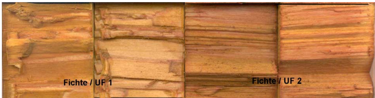
Abb. 41 Universalindikator auf Fichte / UF
