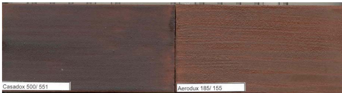
Abb. 50 Eigenfärbung der RPF-Klebstoffe Casadox und Aerodux auf gehobelter Fichte, luftgetrocknet
