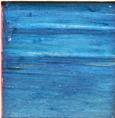
Abb. 44 Methylenblau auf Fichte / UF
