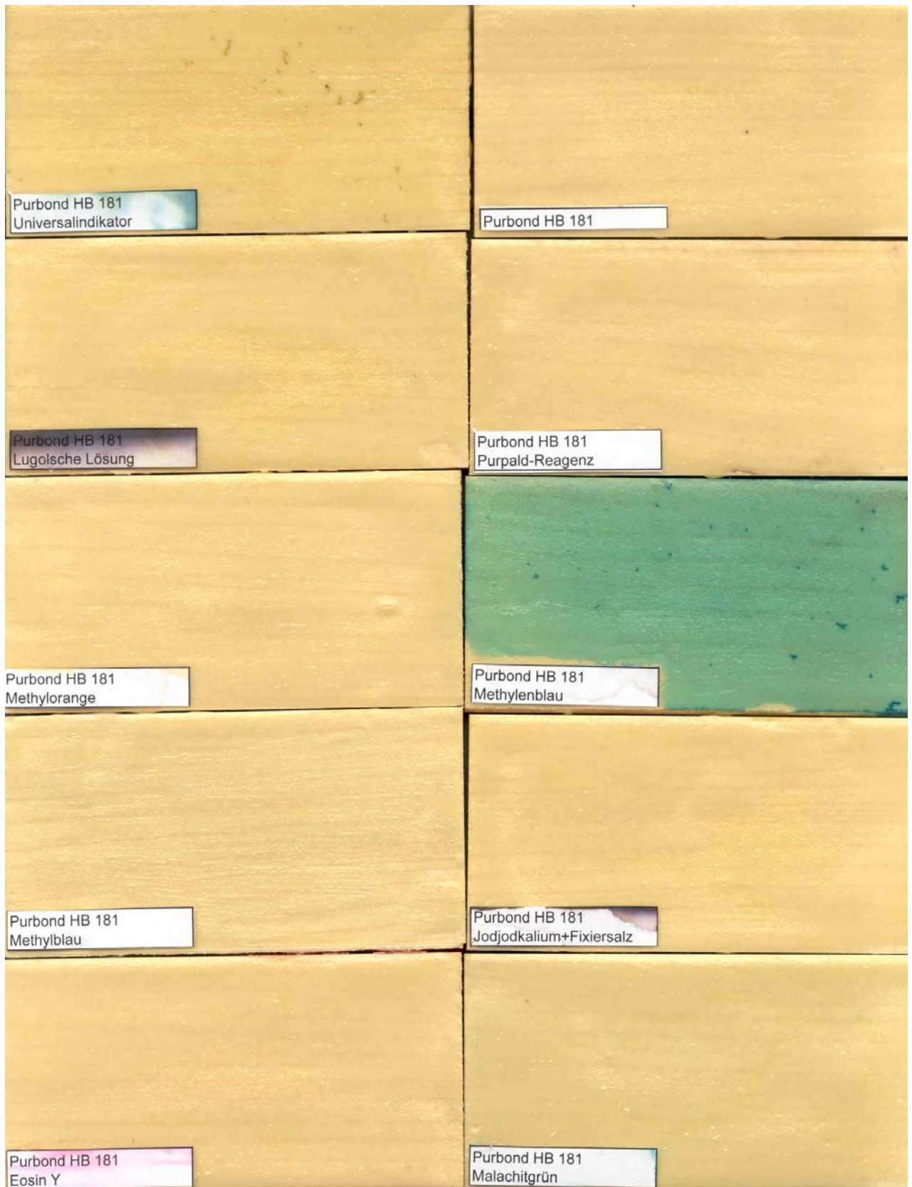
Abb. 19 Farbreaktionen auf Purbond HB 181 luftgetrocknet
