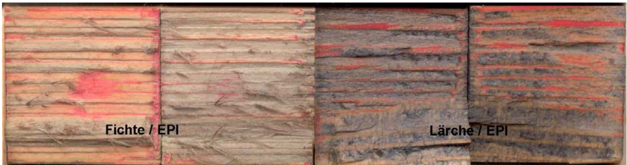
Abb. 49 DACA auf Fichte / EPI bzw. Lärche / EPI
