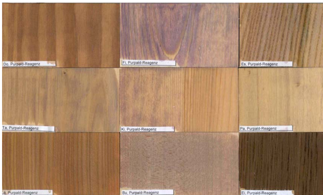
Abb. 15 Gehobelte Holzproben gestrichen mit Purpald-Reagenz, luftgetrocknet
