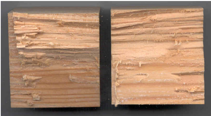
Abb. 1 Bruchfläche einer mit 1P-PUR verklebten Europäischen Lärche
