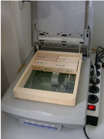
Abb. 57 Scanner mit Bruchproben
