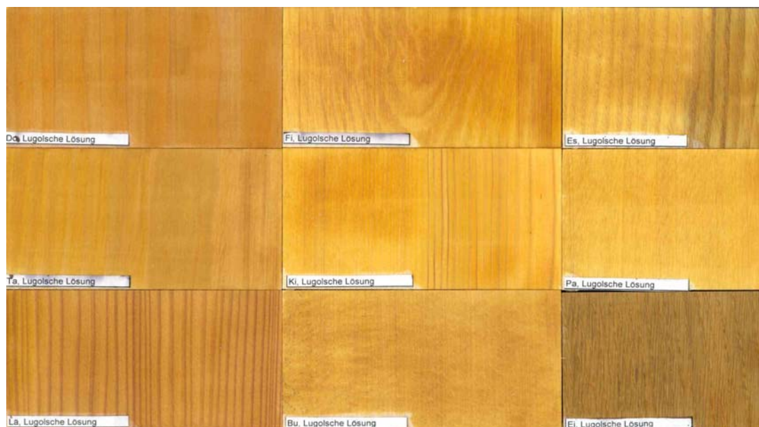
Abb. 13 Gehobelte Holzproben gestrichen mit Lugolscher Lösung, luftgetrocknet
