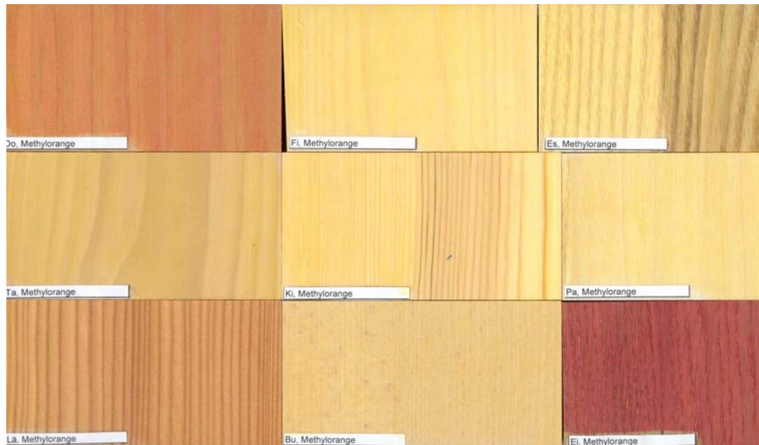
Abb. 12 Gehobelte Holzproben gestrichen mit Methylorange, luftgetrocknet
