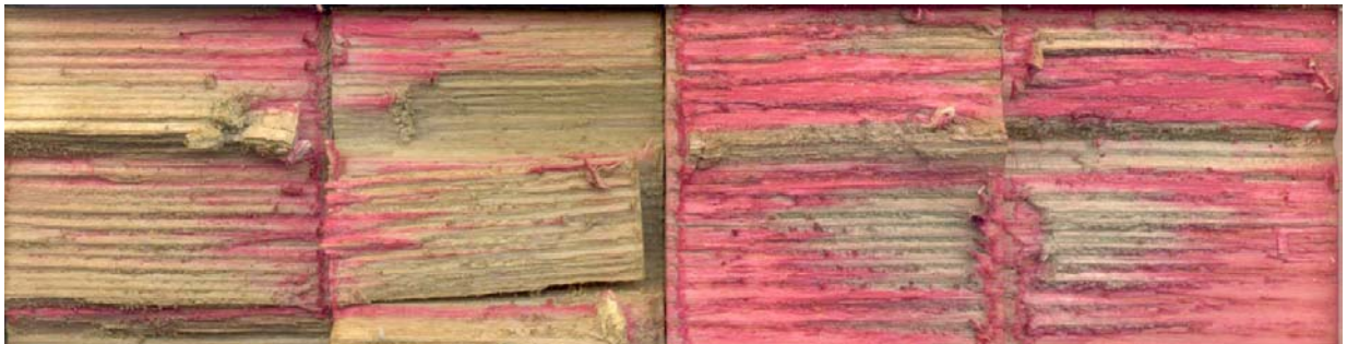
Abb. 40 DACA-Reagenz auf Esche / MUF
