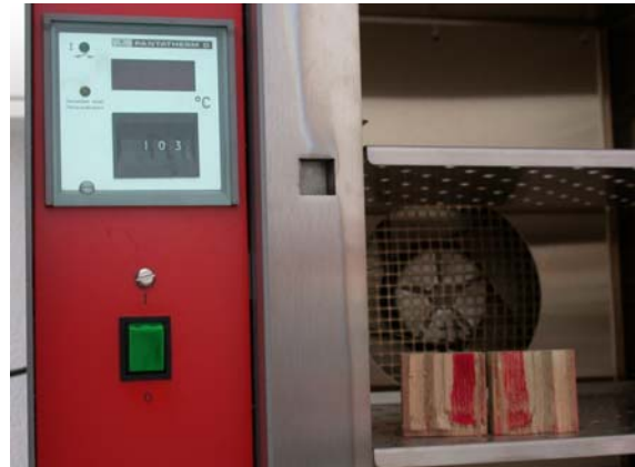
Abb. 62 Trockenschrank zur Wärmebehandlung (20 min bei ca. 100 °C)
