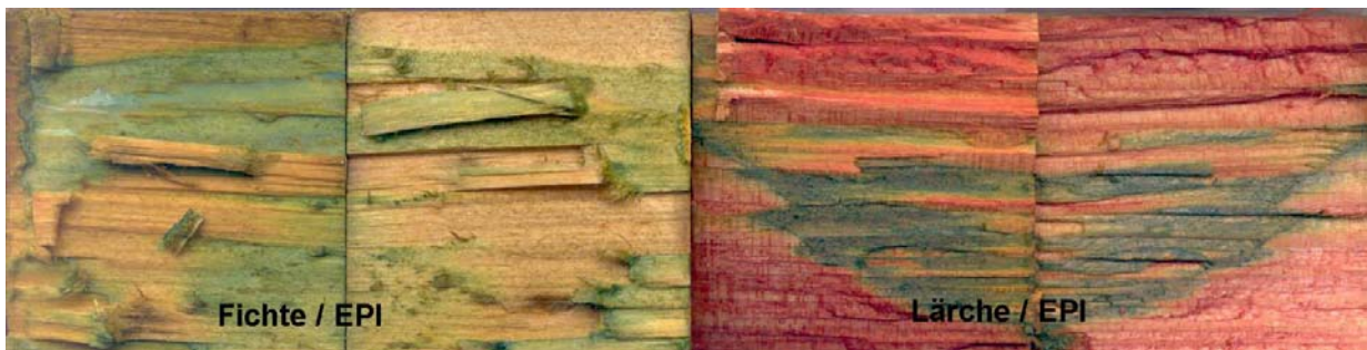
Abb. 48 Universalindikator auf Fichte / EPI bzw. Lärche / EPI
