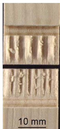
Abb. 4 Probekörper aus Fichte mit 100% Faserbruchanteil
