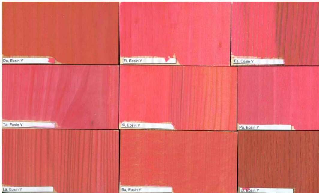
Abb. 10 Gehobelte Holzproben gestrichen mit Eosin G, luftgetrocknet
