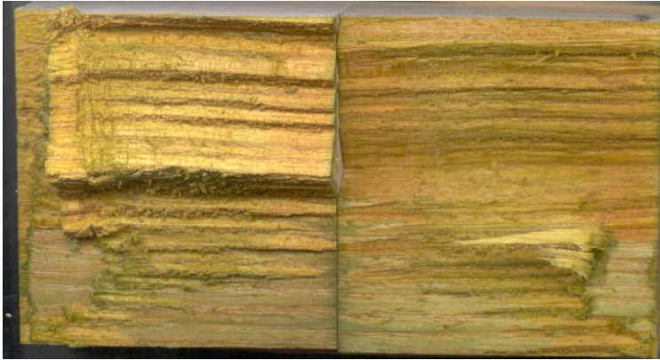
Abb. 39 Universalindikator auf Esche / MUF
