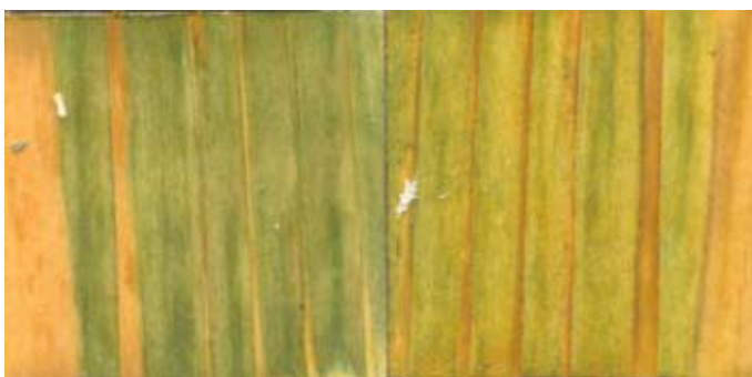
Abb. 81 Bruchfläche mit Bruch nahe der Grenzfläche
