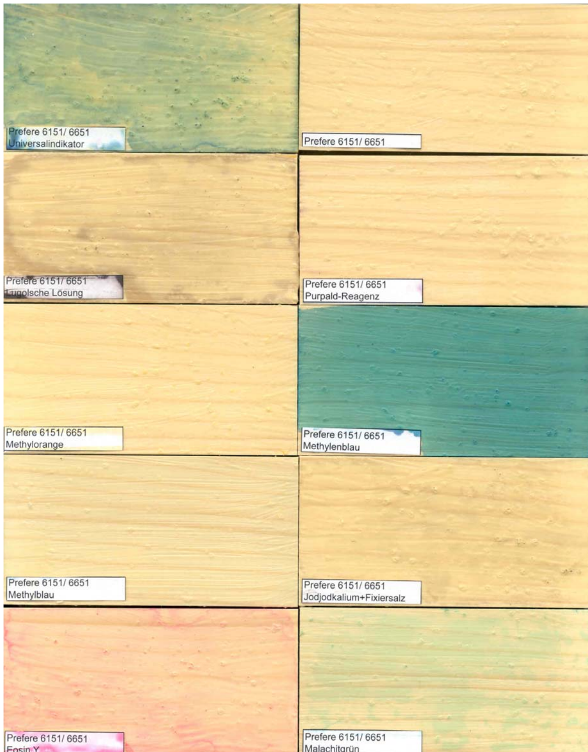
Abb. 28 Farbreaktionen auf Prefere 6151/ 6651 (EPI) luftgetrocknet
