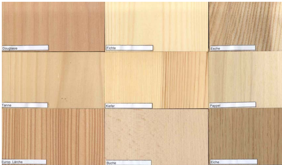
Abb. 7 Gehobelte Holzproben vor der Behandlung
