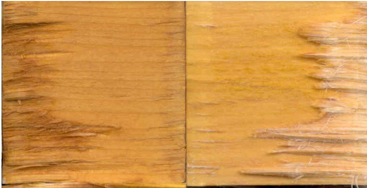
Abb. 36 Lugolsche Lösung anschl. Natriumthiosulfat-Lsg. auf Fichte / PUR
