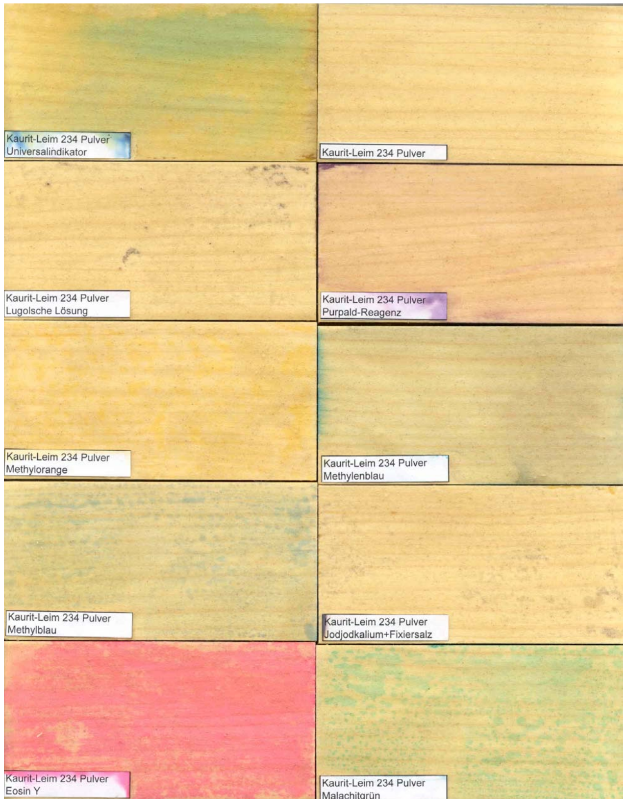
Abb. 27 Farbreaktionen auf Kaurit-Leim 234 Pulver /Härter 70 (UF) luftgetrocknet
