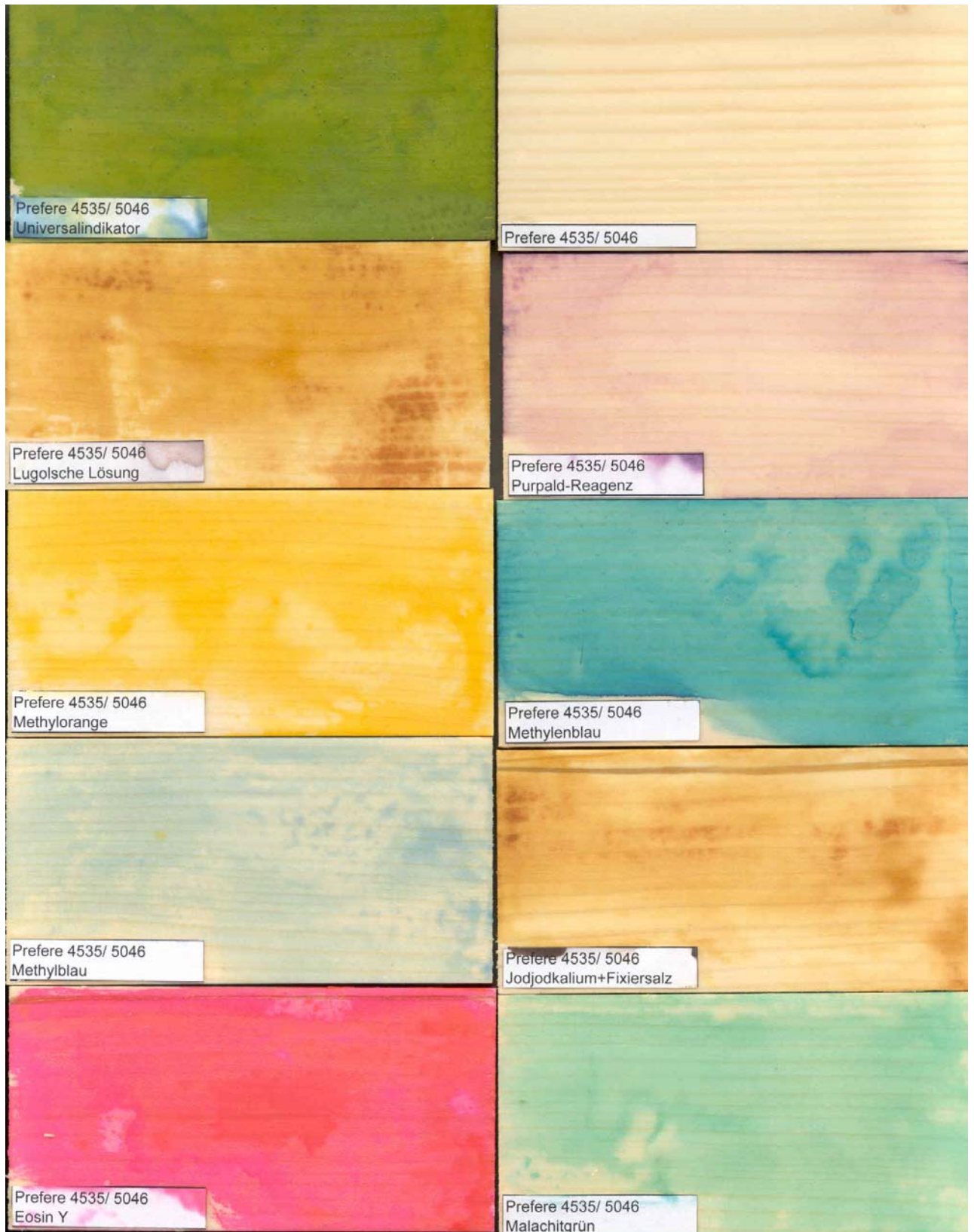
Abb. 23 Farbreaktionen auf Prefere 4535/5046 (MUF) luftgetrocknet
