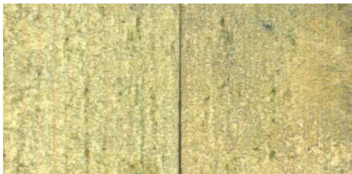
Abb. 75 Bruchfläche mit Kohäsionsbruch im Klebstoff
