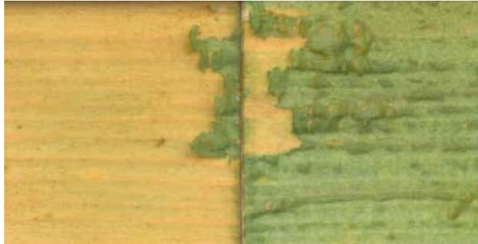
Abb. 77 Bruchfläche mit Adhäsionsbruch
