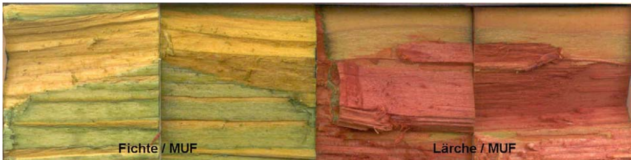
Abb. 37 Universalindikator auf Fichte / MUF bzw. Lärche / MUF
