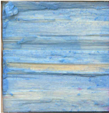
Abb. 42 Methylblau auf Fichte / UF
