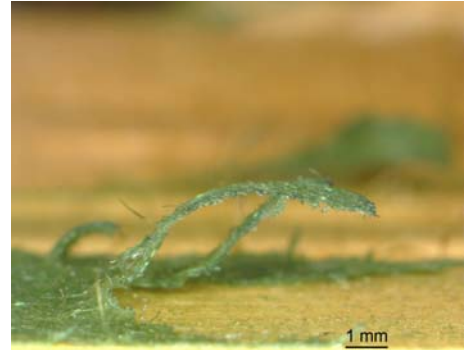
Abb. 78 Abgelöste Klebfuge eines Adhäsionsbruchs
