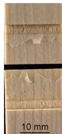
Abb. 5 Probekörper aus Fichte mit 0% Faserbruchanteil
