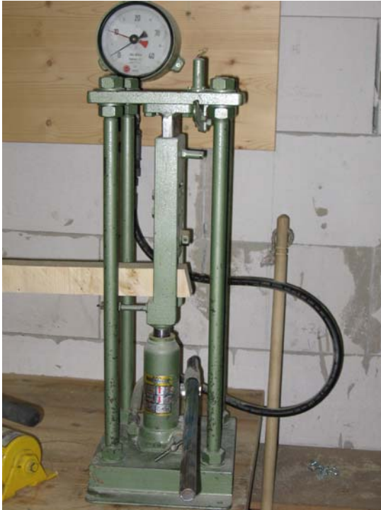
Bild 4.7: Herkömmliche Prüfeinrichtung der neuen Holzbau AG, Lungern zur Durchführung der Scherprüfung von Klebfugen gemäss EN 392: 1995.
