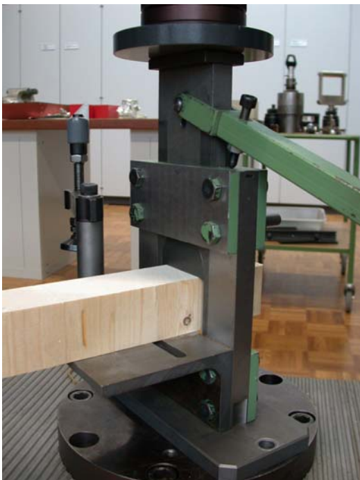
Bild 5.2: Herkömmliches Prüfgerät der Empa zur Durchführung von Scherversuchen gemäss EN 392:1995
