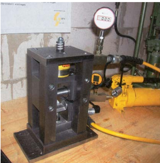
Bild 2.3: Prototyp einer neuen Prüfeinrichtung für Scherversuche [6]
