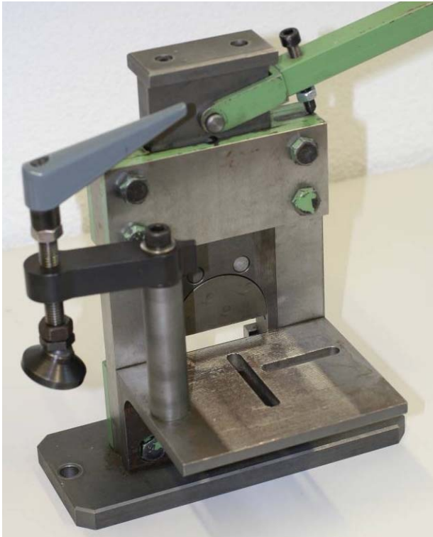
Bild 6.1: Herkömmliche Prüfeinrichtung der Empa zur Durchführung von Scherversuchen
