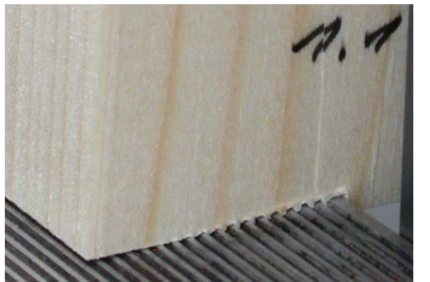
Bild 6.12: Abheben des Prüfkörpers während des Versuchs (linke Seite) und Eindrückungen (rechte Seite)
