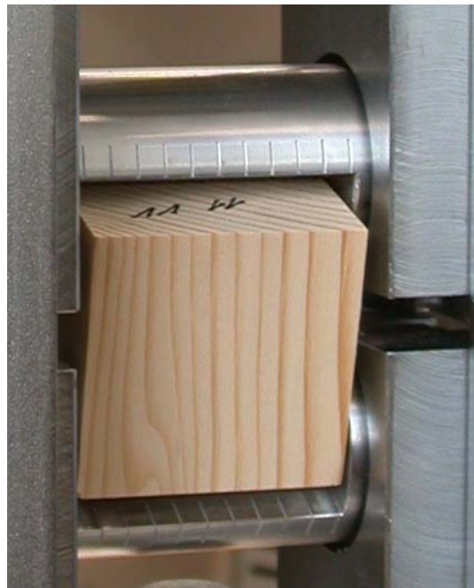
Bild 5.3: Neues Prüfgerät der Empa zur Durchführung von Scherversuchen gemäss EN 392:1995
