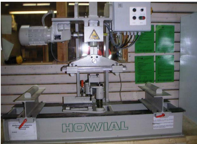
Bild 3.15: Universalprüfgerät für die Qualitätskontrolle von BSH, hergestellt durch die Firma Howial (Bild: E. Schliiger)
