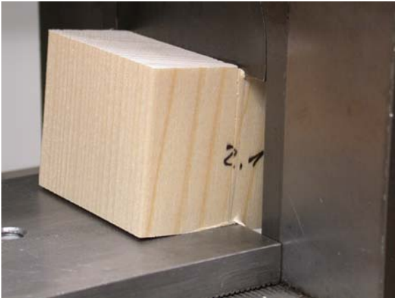
Bild 6.7: Abheben eines Prüfkörpers der Versuchsserie „Auflage auf glatter Stahlplatte“
