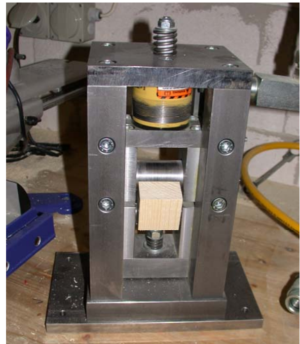
Bild 4.4: Prototyp einer neuen Prüfeinrichtung für Druckschertests schräg zur Faser, entwickelt durch Prof. em. E. Gehri und Zum Wald Maschinen- und Apparatebau, Erlenbach im Simmental für die neue Holzbau AG, Lungern [13]
