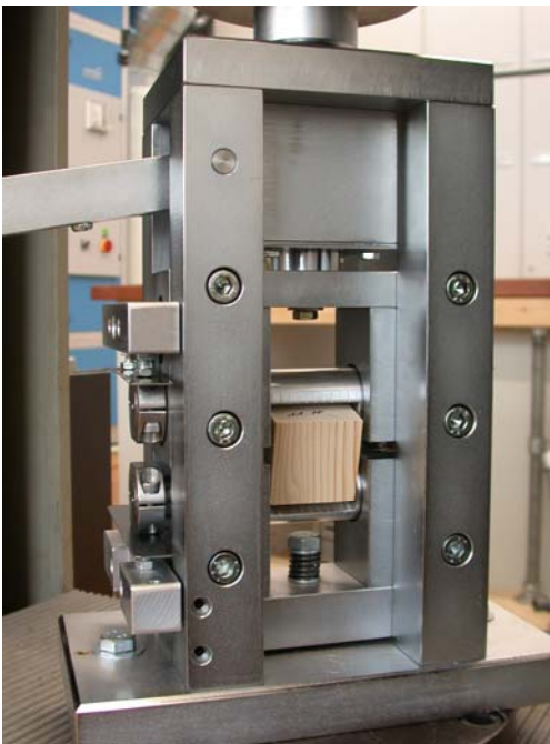
Bild 5.3: Neues Prüfgerät der Empa zur Durchführung von Scherversuchen gemäss EN 392:1995
