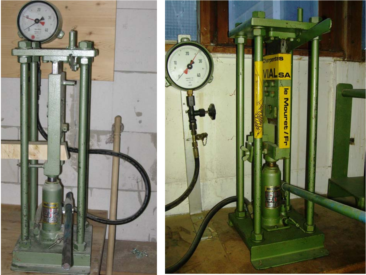
Bild 3.14: Scherprüfgerät der Firma Lübbert Warenhandel GmbH: Gesamtansichten
