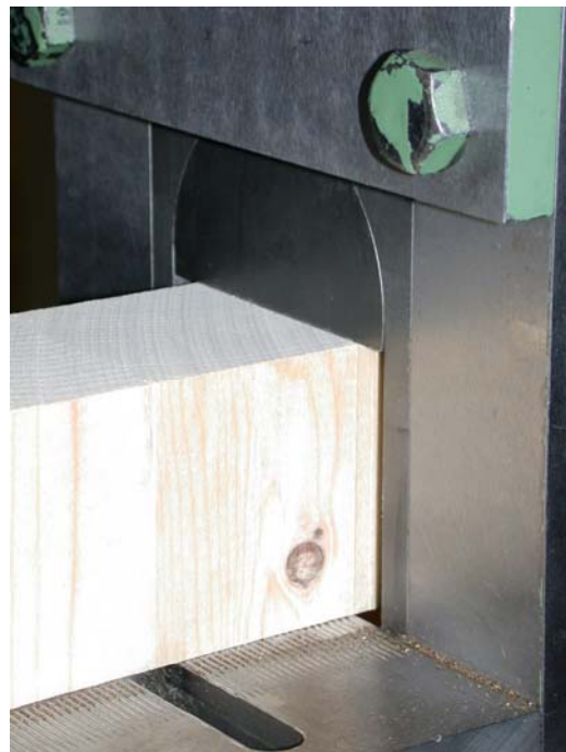
Bild 5.2: Herkömmliches Prüfgerät der Empa zur Durchführung von Scherversuchen gemäss EN 392:1995
