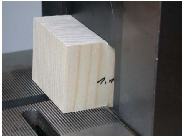
Bild 6.10: Auflage auf geriffelter Stahlplatte: Bruchzustand
